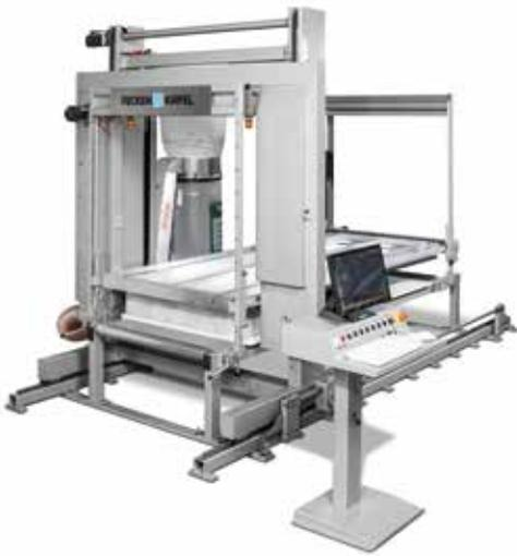
O poderoso sistema de aspiração reduz a formação de poeira ao mínimo. O dispositivo de retenção pode ser deslocado para baixo durante o processo de corte se o bloco cair. A máquina acelera o fio de corte até 324 km / h (200 milhas / hora). Para compensar o comprimento do fio, a tensão é controlada pneumáticamente.
