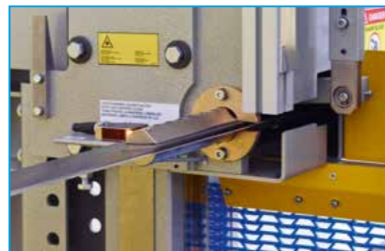
Regulación del ángulo de la cuchilla sinfín (S 20 – S 36)
